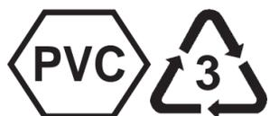
È il simbolo del **Polivinilcloruro**, utilizzato per fabbricare, ad es., i tubi degli scarichi fognari. Occorre evitare assolutamente di metterlo nella plastica differenziata a causa della presenza del cloruro, che danneggia il processo.
